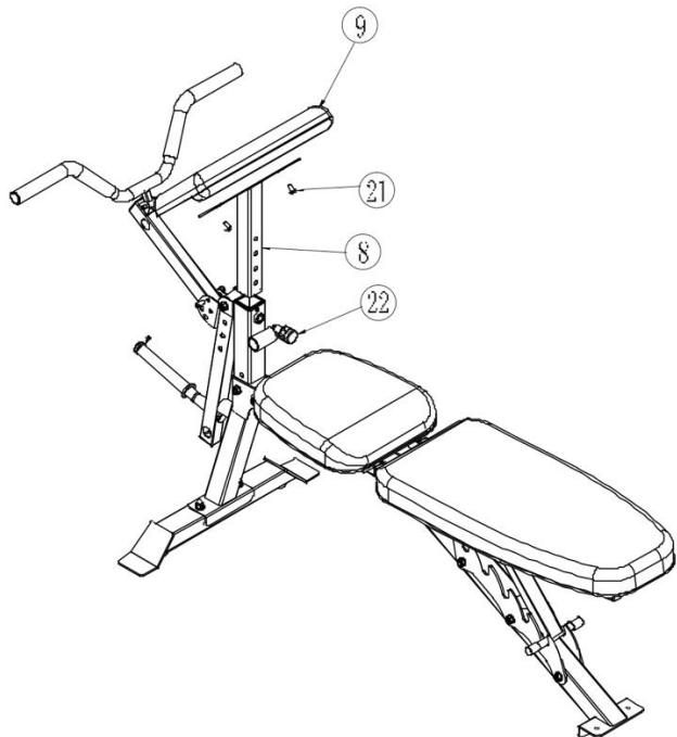
1. Вставьте регулировочную стойку (8) в переднюю опору (2), сопоставляя отверстия, затем зафиксируйте детали с помощью штифта (22).
