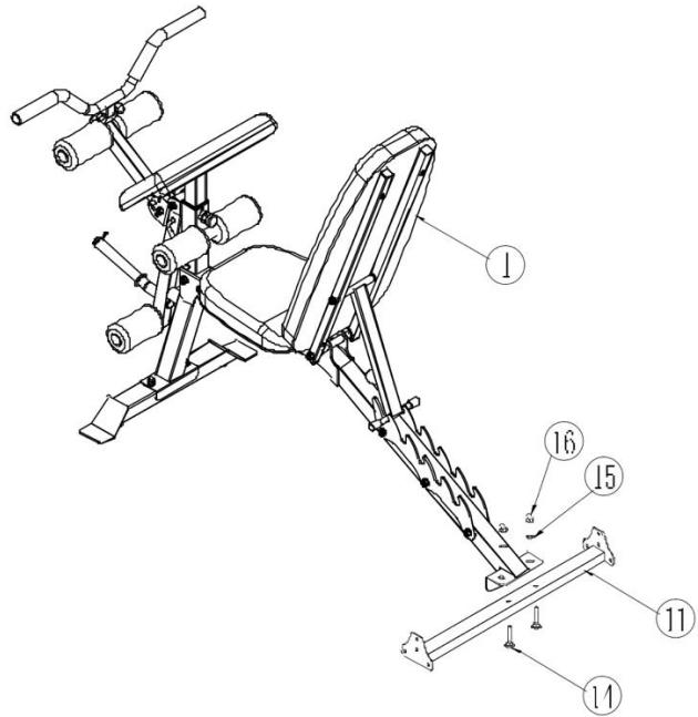
Установите задний стабилизатор (11) на основную раму и используйте два болта №14 М10x50, две плоские шайбы (15), две шестигранные гайки M10 (16), ключ с открытым концом № 15-13-17, чтобы зафиксировать детали.
