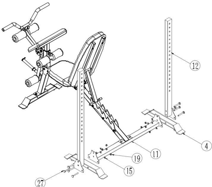
1. Вставьте винты (27) в отверстия на силовой рама (12), стабилизаторе (4) и нижней рамы для гантелей (11), затем и используйте открытый ключ (28), плоскую шайбу (15)
