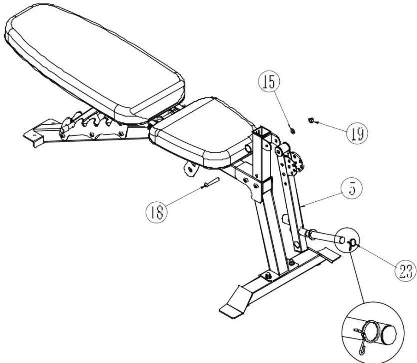
1. Установите переднюю регулировочную стойку (2) на основную раму (1), затем с помощью шестигранного болта (18), плоской шайбы (15), стопорной гайки (19), ключа (28), шестигранного ключа (30) и кольца Ø25 (23) закрепите детали.
